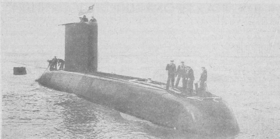
Рис. 2. Чилийская дизельная торпедная подводная лодка типа «Томсон», построенная в Германии и модернизированная на судостроительной компании АСМАР
